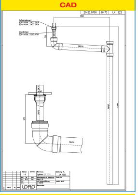
Wasserhöhe 20 50 70 75 mm 10 15 25 30 35 40 45 55 60 65 **Abfluss** l/s 0,75 0,90 1,10 1,20 1,25 1,30 1,40 1,50 1,55 1,60 1,65 1,70 1,75 1,80 **Silent**
